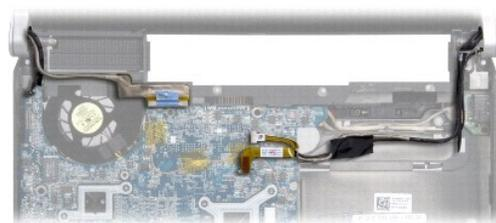
7. Remova o parafuso de aterramento do cabo da tela que prende o cabo de aterramento da tela à placa de sistema.
