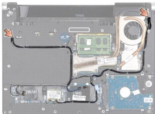
5. Puxe os cabos da Mini-Card da placa de sistema de forma a liberá-los da base do computador.
